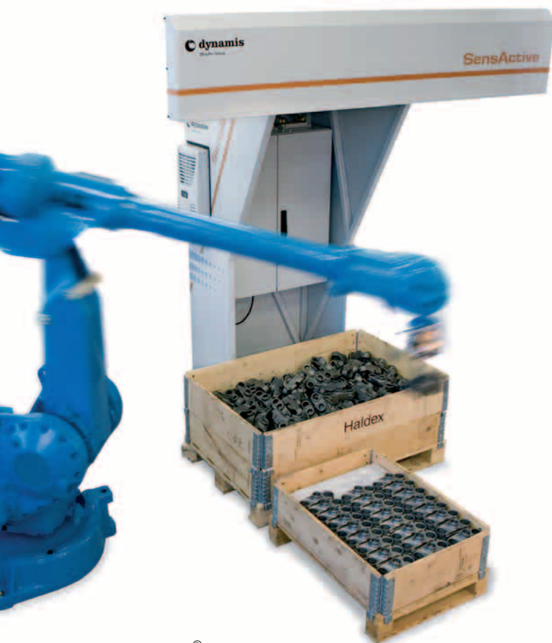
SensActive® Bin Picking zur Teileentnahme (hier mit Roboter sowie Musterlegungsmodul).
